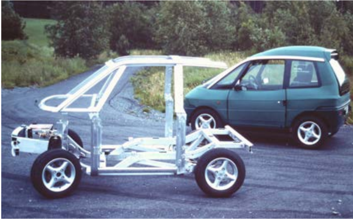
Aluminiumsramma til en tidlig PIV3 (bilen avbildet på neste side) sammen med en av OL-bilene i Aurskog i april 1994. Bare et fåtall av de første bilene ble i Norge. (Foto: Håkon Aurlien)
